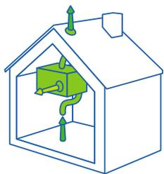
**3** Une ventilation mécanique contrôlée optimisée (hygro-réglable de type B ou double flux avec récupération de chaleur).
